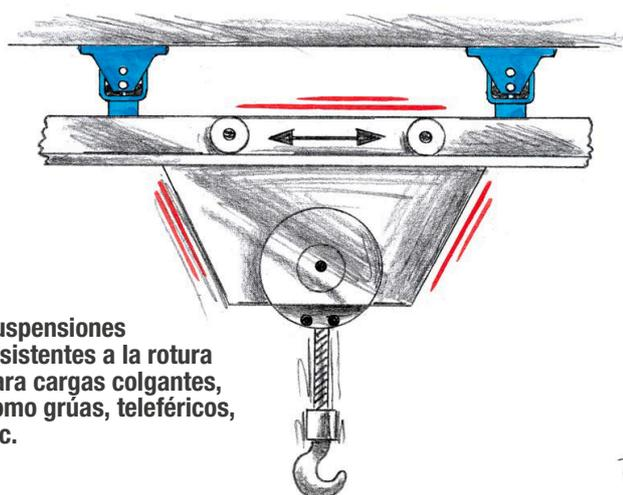
Suspensiones resistentes a la rotura para cargas colgantes, como grúas, teleféricos, etc.
