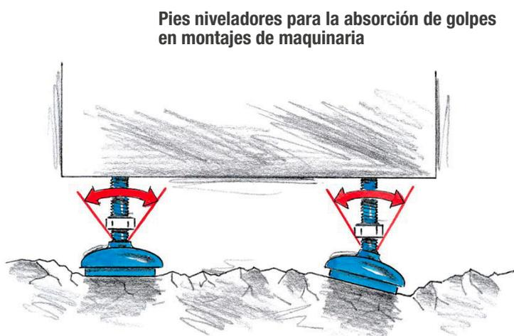
Pies niveladores para la absorción de golpes en montajes de maquinaria
