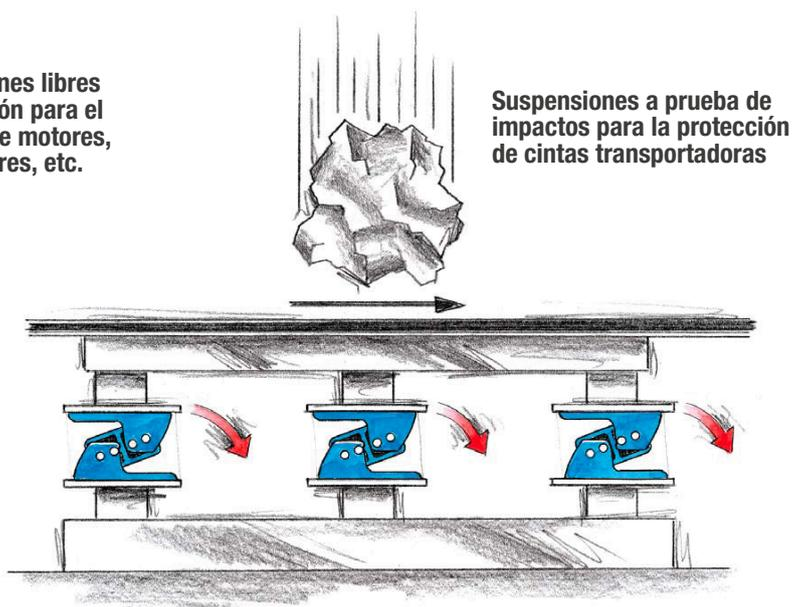
Suspensiones a prueba de impactos para la protección de cintas transportadoras
