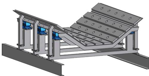
Las estaciones de transferencia equipadas con amortiguadores de vibraciones ROSTA tipo ESL ofrecen una característica de desviación progresiva que amortigua eficazmente la energía cinética creada cuando el material que cae hace impacto. Esto protege la superficie del revestimiento de la banda contra el agrietamiento, reduce mucho el nivel de desgaste continuo del material y protege la subestructura contra un fallo prematuro.
