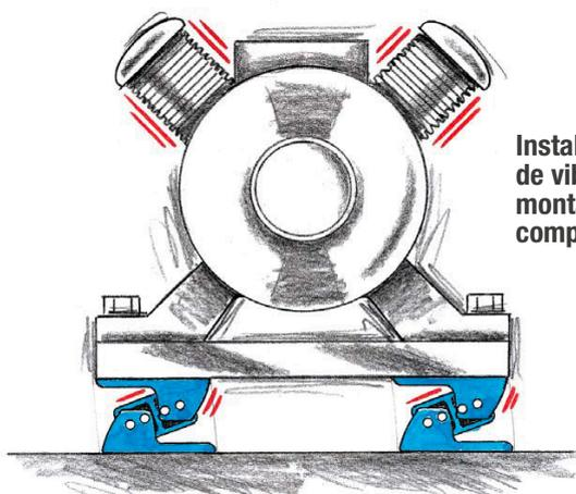
Instalaciones libres de vibración para el montaje de motores, compresores, etc.
