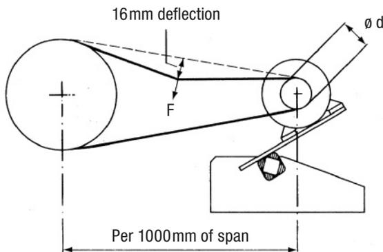
\* Fuerza de prueba necesaria para una desviación de la correa de 16 mm por cada 1000 mm de distancia central. La desviación relevante por distancia central más corta o más larga es proporcional a 16 mm/m. Los valores pueden variar según el proveedor de la correa.
