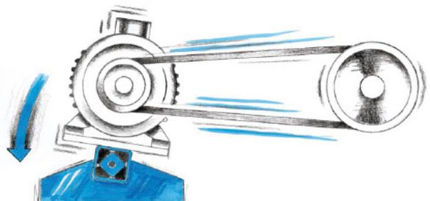
Sistema de tensado automático y sin mantenimiento.
